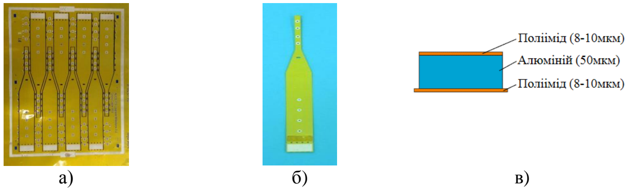
Рисунок 11 – Дослідні зразки поперечних кабелів: а) підкладка з поперечними кабелями; б) одиничний поперечний кабель; в) структура поперечного кабелю
