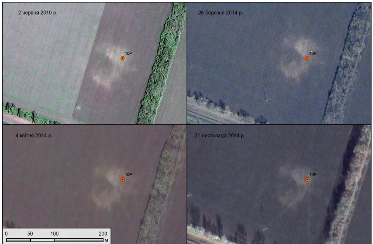
Рисунок 2.5 – Контури техногенно порушених земель в районі свердловини на різних за часом космічних знімках
