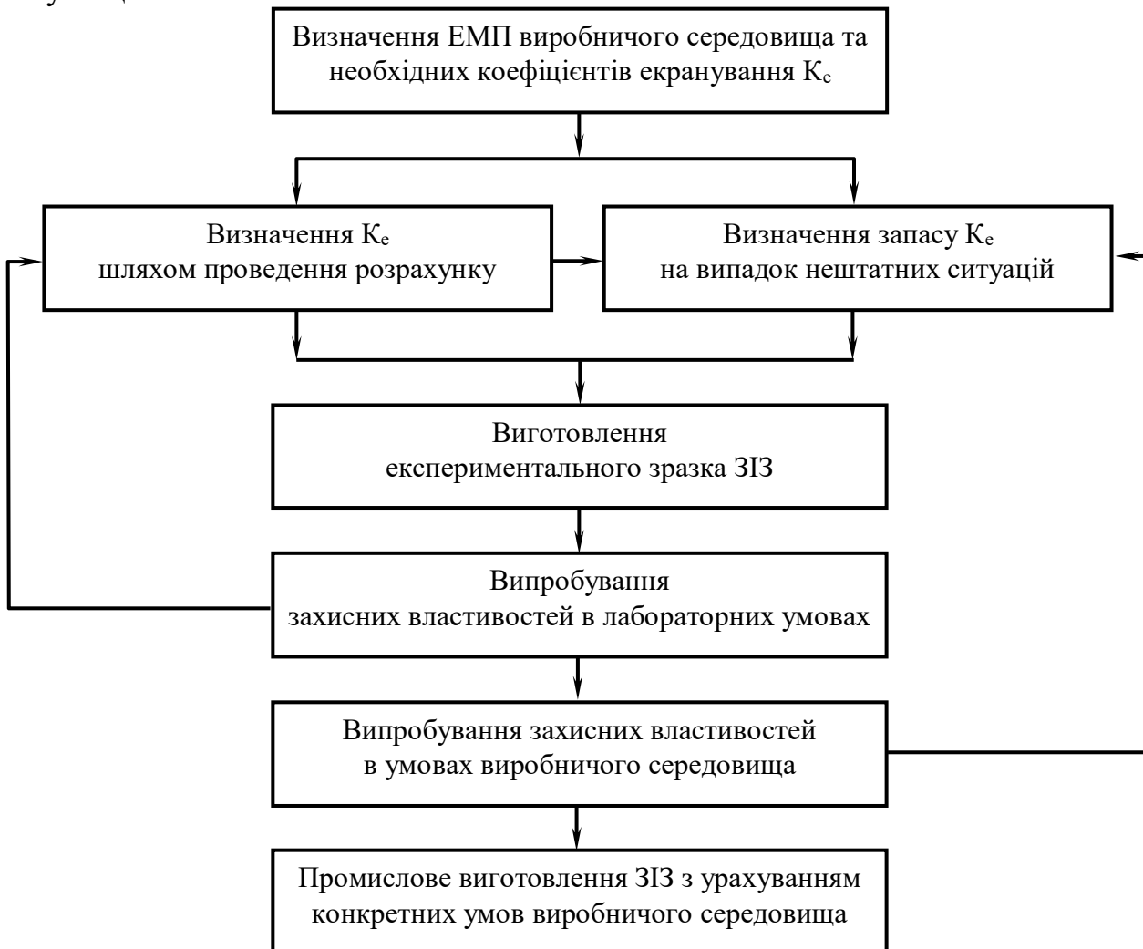
Рисунок 11 – Схема проектування та виготовлення ЗІЗ для захисту працюючих від впливу електромагнітних полів
