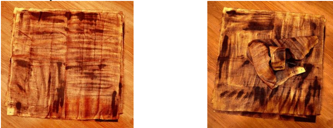
Рисунок 4 – Зовнішній вигляд захисного матеріалу на основі льняного полотна та нанозаліза
