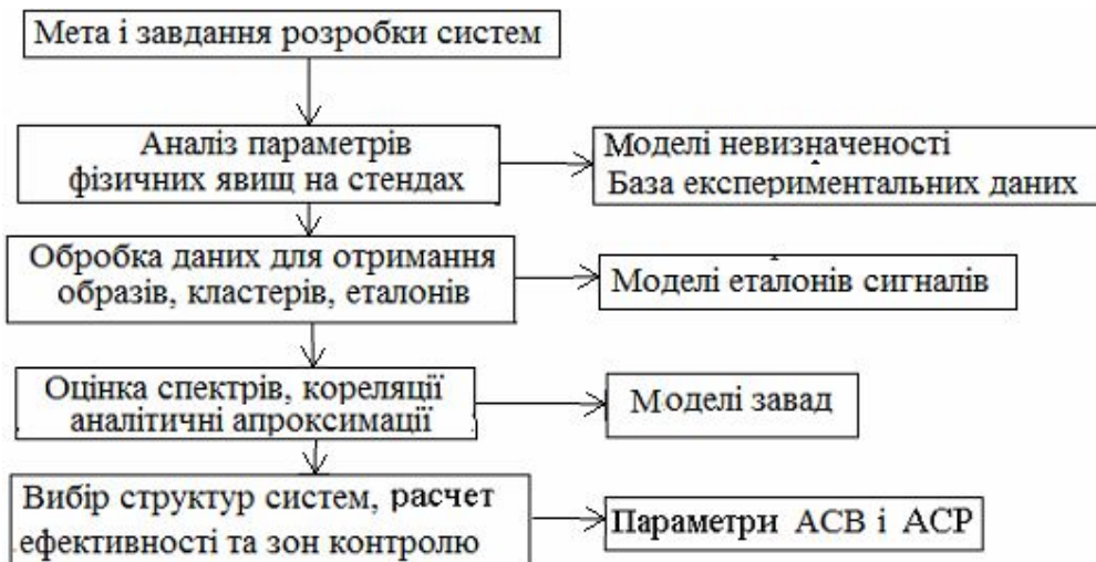
Рис.6. Інформаційна технологія моделювання АСВ і АСР
