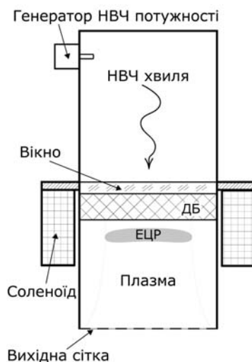
Рис. 41. Схематичний вигляд резонаторної системи низького тиску робочого газу, досліджуваної в поточному розділі (ДБ – діелектричний блок, ЕЦР – область електронного циклотронного резонансу)
